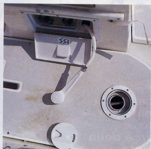
La zona centrale di seduta del timoniere è amovibile e comunica direttamente con lo specchio di poppa. Nella foto la doccetta, calda e fredda, esterna.
